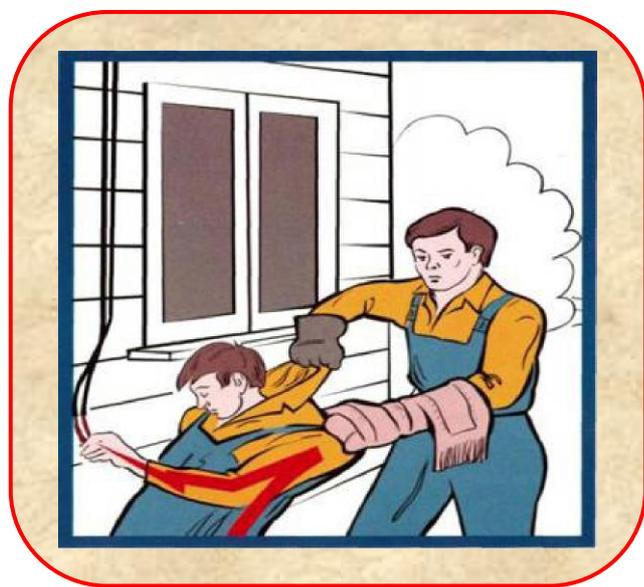
Рис.6. Освобождение пострадавшего от токоведущей части, находящейся под напряжением до 1000 В
